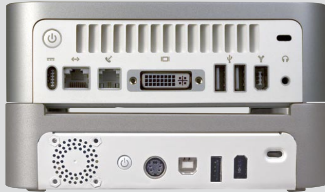
Rear view of Mac mini stacked on top of LaCie mini Hard Drive & HUB (Mac mini sold separately)
